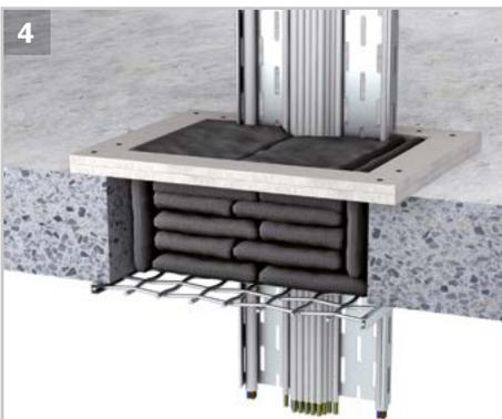
Bei einer Bauteildicke < 250 mm muss das Bauteil mittels nicht-brennbaren Bauplatten auf die erforderliche Mindestdicke von 250 mm aufgedoppelt werden. Zur Fixierung der Brandschutzkissen in der Bauteilöffnung dient ein deckenunterseitig angebrachtes Stahlgitter.
