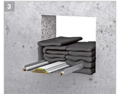
Die weiteren Lagen der Brandschutzkissen so dicht wie möglich um die Kabel legen. Darauf achten, dass zur optimalen Ausnutzung der Öffnung verschiedene Kissengrößen verwendet werden.
