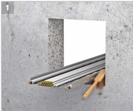
Die Öffnung reinigen und alle losen Teile entfernen. Die Befestigung der Kabelpritsche an der Wand bzw. Decke überprüfen. Diese sollte ca. 25 cm nach der Wand oder Decke erfolgen.
