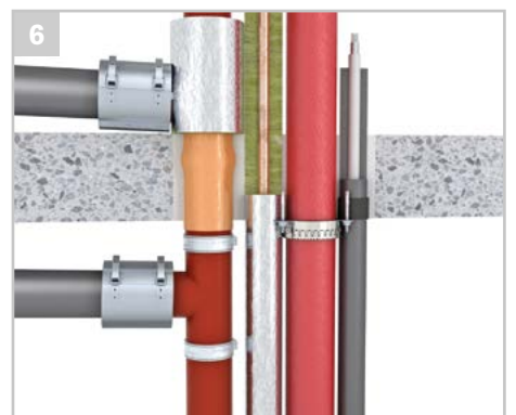
Andere Abschottungen für brennbare oder nichtbrennbare Rohre können bei Brandschutz-Systemen der Rolf Kuhn GmbH mit „Nullabstand“ verlegt werden.
