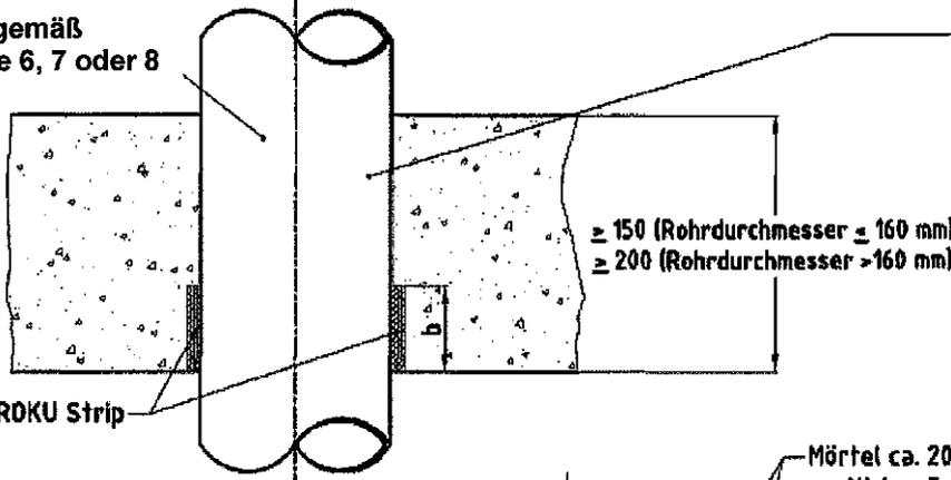
Bei dieser Variante der Fugenverfüllung darf ggf. ein Streifen aus PE – Weichschaum ( $d \leq 5 \text{ mm}$ ) eingebaut werden; (s. Anlagen 4 bis 8 und Abschnitt 4.4.3); Abstand zwischen benachbarten Umwicklungen dann  $\geq 100 \text{ mm}$
